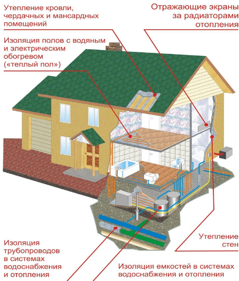
Рис. 2. Пример использования вспененного полиэтилена на объектах строительства
